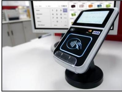
ACR123S は費用対効果の高い柔軟でインテリジェントな非接触リーダです。ACR123S インテリジェント非接触リーダはより便利なキャッシュレスペイメントシステムを可能にすべく、既存の POS キャッシュレス決済システムやレジとの統合が可能です。13.56 MHz 非接触式（RFID）技術をベースに開発され、それは、ISO 14443-4 規格の非接触カードをサポートしています。
